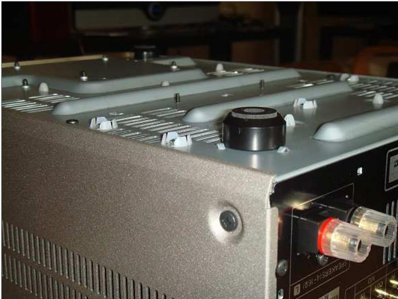
Der hochwertige Aufbau dämpft auch effektiv Resonanzen, was ebenfalls zur sehr guten Klangqualität des R-K1 CD-Receiver's beiträgt
